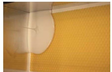
Fig. 4: Met een dunne straal word de siliconen vanuit 1 plaats gegoten, hierdoor duwt de siliconen onder het vloeien de lucht voor zich uit.
